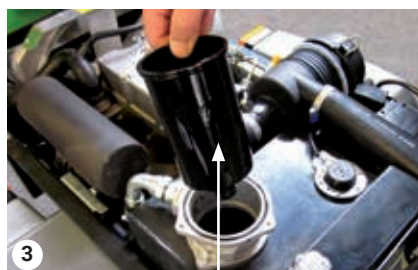
3 Obudowa filtra zbiornika
